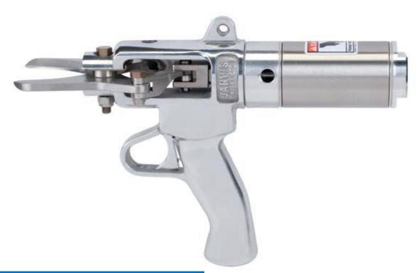
Модель Jarvis CPE - секатор с пневматическим приводом для удаление лапок и шей у кур, идеек, уток, гусей и игровой птицы.
